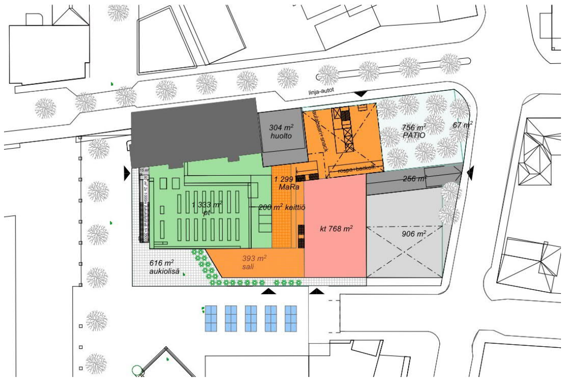
E, kuva E1. Viitesuunnitelma, kaavoitus 30.11.2019 (XXI kerrosta), jossa hotellin (oranssi väri) torniosa on sijoitettu Korkalonkadun varrelle ja Pekankadun ja Korkalonkadun risteyksessä puistikko (756 m 2 ) hotellin patioalueeksi. Päivittäistavarakauppa (pt/vihreä) sijaitsee Lordiaukion puolella. Aukion lisäpinta-ala noin 600 m 2 .
